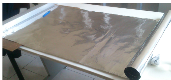
شکل ۳: نمایی از فویل آلومینیومی انتخاب شده برای ساخت نمونه مهندسی (آلومینیوم سری ۸۰۰۰)
