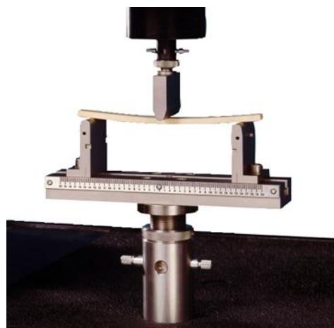
شکل ۶: نمایی شماتیک از تست خمش پیشنهادی برای ساندویچ پنل ساخته شده از لانه زنبوری‌های نمونه
